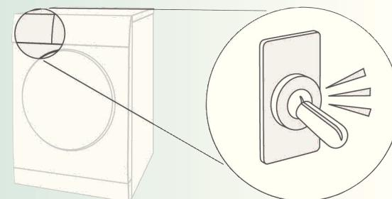
Den automatiske rengøring af tørretumbleren afgiver en klikkende lyd.
