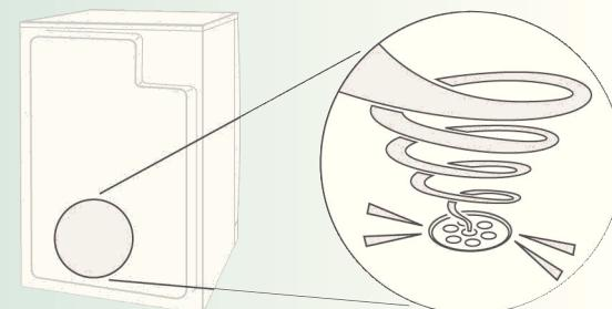
Kondensvandet bliver pumpet ind i kondensvandsbeholderen, hvorfra der opstår pumpelyde.
