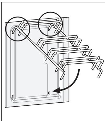
2. **Installation correcte :** les deux crochets doivent être complètement insérés dans les trous situés dans le haut de la paroi. Déplacez ensuite le support vers le bas, lentement et avec précaution, et insérez les crochets inférieurs.
