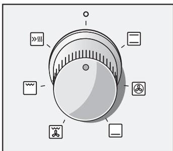
Le sélecteur de mode de fonctionnement permet de régler le mode de cuisson du four.
