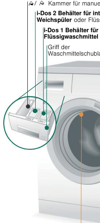
Trommelinnenbeleuchtung (je nach Modell) - nach Öffnen oder Schließen des Einfüllfensters, sowie nach Programmstart; erlischt selbsttätig.
