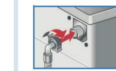
1. Selon le modèle : Raccordez le flexible d'arrivée d'eau (les flexibles) à un robinet d'eau (aux robinets d'eau) 3/4" = 26,4 mm et à l'appareil. **Attention :** Ne serrez les raccords qu'à la main.
