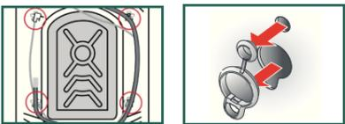
2. Installez toutes les cales de transport. Ce faisant, orientez les coudes des fixations du flexible vers l'intérieur. Fixez le cordon d'alimentation dans les fixations. Serrez les vis.
