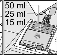
**Reiniger** nur in trockene Reinigerkammer einfüllen.
