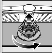
Tournez le cylindre filtrant, retirez le système de filtration ...
