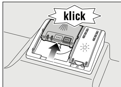
Le compartiment à détergent s'ouvre automatiquement au moment optimal, en fonction du programme. Le détergent en poudre ou liquide se répartit dans l'appareil et se dissout, la pastille tombe dans la coupelle interceptrice de pastille et s'y dissout de façon dosée.
