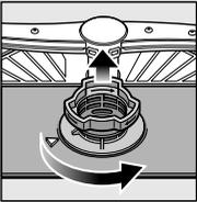
Siebzylinder drehen, Siebssystem entnehmen ...
