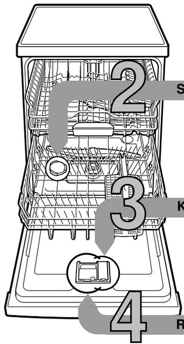
**Spezijsalz einfüllen** Löst Kalk (nicht nötig bei Einstellwert 0!) ...
