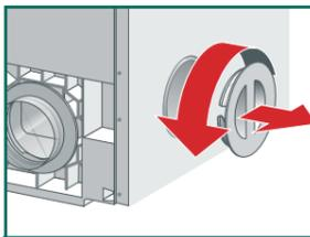
2. Retirar el anillo de bayoneta en la placa posterior y fijarlo en la abertura de la placa lateral.
