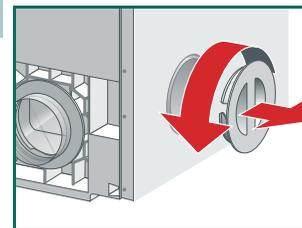
2. Retirar el anillo de bayoneta en la placa posterior y fijarlo en la abertura de la placa lateral.
