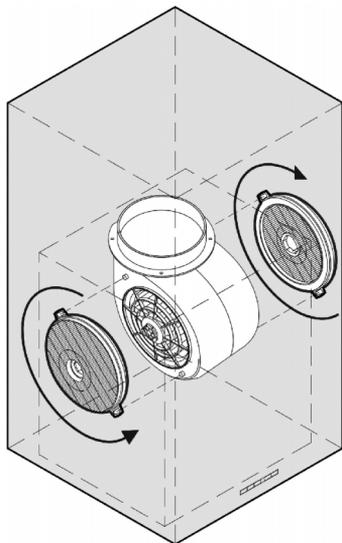
3. Ruotare i filtri nel senso della freccia finché non s'innestano. I filtri montati correttamente non possono più essere staccati.
