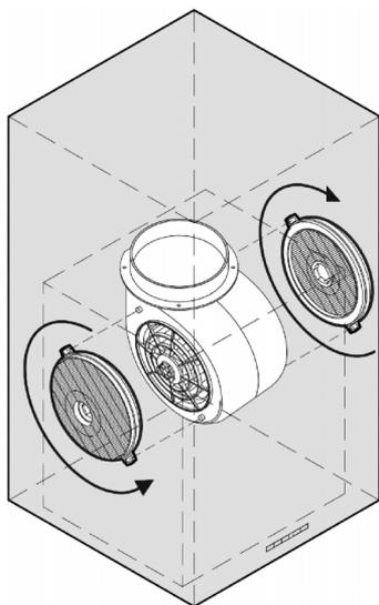
3. Girar los filtros en la dirección que marca la flecha, hasta que enclaven. Si los filtros se han montado correctamente, no se pueden retirar.
