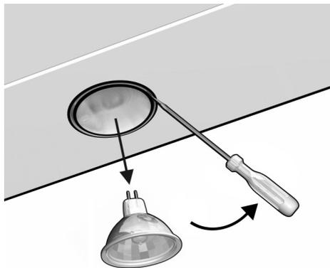
**Attenzione:** in caso di rimozione non corretta, possibile danneggiamento dell'apparecchio.
