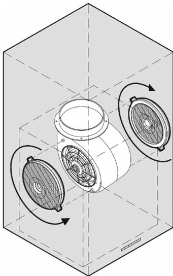
3. Vrid filtren i pilens riktning tills de sitter fast. Filtren är rätt monterade när de inte längre går att dra av.
