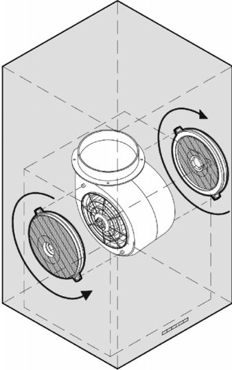
3. Drehen Sie die Filter in Pfeilrichtung bis sie einrasten. Sind die Filter richtig montiert, lassen sie sich nicht mehr abziehen.
