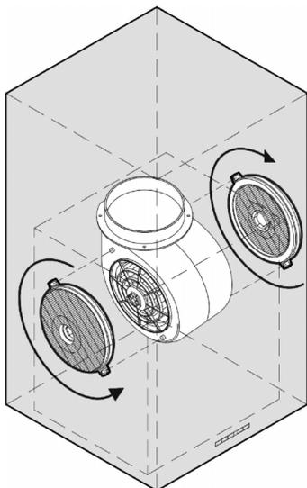
3. Drej filterne i pilens retning, til de falder i hak. Er filterne monteret rigtigt, kan de ikke mere fjernes.
