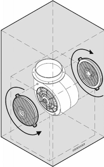
3. Draai de filters in de pijlrichting tot ze vastzitten. Wanneer de filters goed zijn gemonteerd, kunnen ze niet meer worden losgetrokken.
