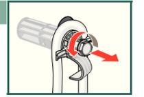
3. Rimuovere completamente tutti i 3 fermi di trasporto e, a seconda del modello, togliere il cavo di alimentazione dai supporti.
