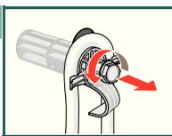
3. Rimuovere completamente tutti i 3 fermi di trasporto e, a seconda del modello, togliere il cavo di alimentazione dai supporti.
