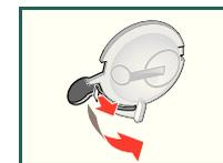
2. Montare i due fermi di trasporto inferiori, tenendo l'archetto del supporto tubi flessibili sempre rivolto verso l'interno. Agganciare il cavo di alimentazione nel supporto. Stringere le viti.
