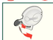
2. Montare i due fermi di trasporto inferiori, tenendo l'archetto del supporto tubi flessibili sempre rivolto verso l'interno. Agganciare il cavo di alimentazione nel supporto. Stringere le viti.
