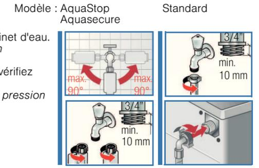
1. Raccordez le flexible d'arrivée d'eau au robinet d'eau. **Attention :** Serrez le raccord à vis à la main uniquement.
