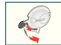
2. Montez les deux cales de transport inférieures. Tournez le coude des colliers-supports des flexibles vers l'intérieur. Calez le cordon d'alimentation dans les supports. Serrez les vis.
