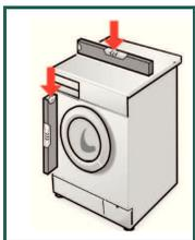
3. Serrez le contre-écrou contre le corps de l'appareil. Ce faisant, maintenez le pied et veillez à ce que sa hauteur ne change pas.
