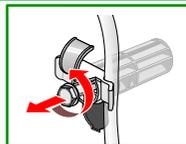
3. Odstraňte kompletně všechny 4 dopravní pojistky a síťový kabel vyjměte z držáků.
