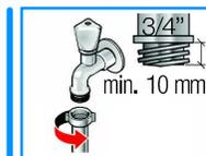
2. Otevřete opatrně vodovodní kohoutek a zkontrolujte přítomnost těsnost připojovacích míst.
