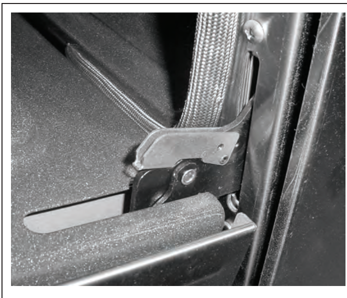
Photo B : Faites basculer la griffe vers l'extérieur
