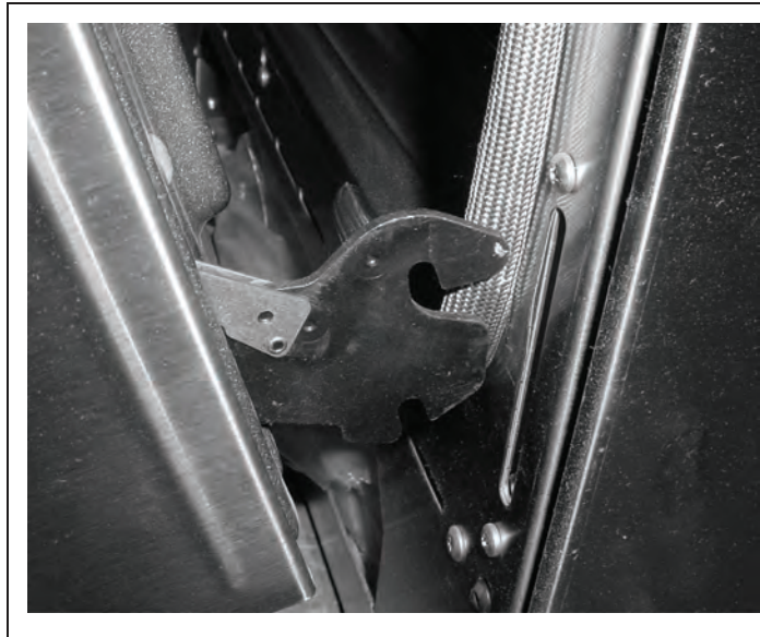
Photo C : Charnière retirée du four
