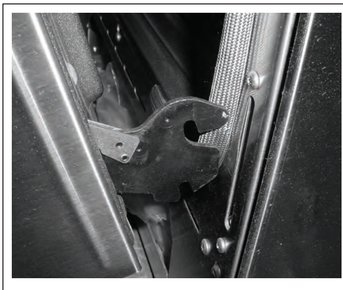
Foto C: Bisagra fuera de la hornilla
