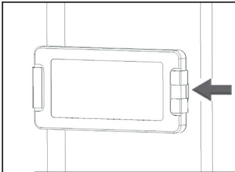
Inserte la punta del destornillador aquí.
