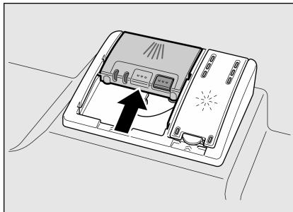
Die Reinigerkammer öffnet sich programmababhängig automatisch zum optimalen Zeitpunkt. Der Pulver- oder Flüssigreiniger verteilt sich im Gerät und wird aufgelöst, der Tab fällt in die Tab-Auffangschale und löst sich dort dosiert auf.
