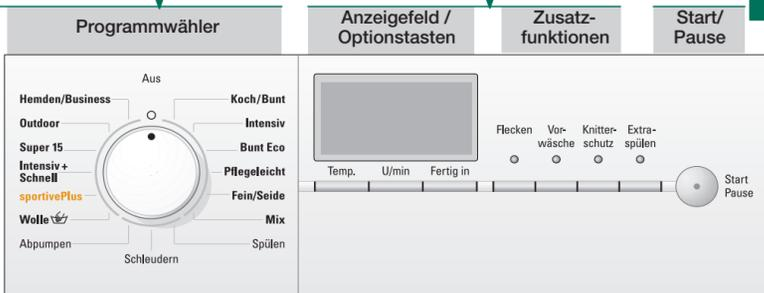
**i** Programmwähler zum Ein- und Ausschalten der Maschine und zum Wählen des Programms. Drehen in beide Richtungen möglich.
