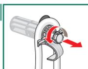
3. Retirez entièrement les 3 cales de transport et retirez le cordon d'alimentation des supports (suivant le modèle).
