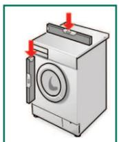
3. Serrez le contre-écrou contre le corps de l'appareil. Ce faisant, maintenez le pied et veillez à ce que sa hauteur ne change pas. **Attention** : les contre-écrous des quatre pieds doivent être fermement vissés contre le corps de l'appareil.
