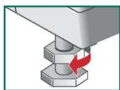
2. Tournez les pieds de l'appareil pour modifier sa hauteur. **Attention** : les quatre pieds doivent fermement reposer sur le sol. Le lave-linge ne doit pas pouvoir bouger. Contrôlez l'horizontalité du lave-linge à l'aide d'un niveau à bulle et rectifiez-la si nécessaire.
