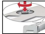
5. Kondenswasserbehälter einschieben bis zum Einrasten.
