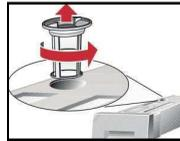
3. Filter unter fließendem Wasserstrahl reinigen.
