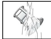
4. Filter einsetzen und bis zum Anschlag eindrehen.
