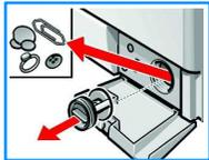
Um zu verhindern, dass beim nächsten Waschen Waschmittel ungenutzt in den Ablauf fließt: 1 Liter Wasser in Kammer II gießen und Programm **Abpumpen** wählen.
