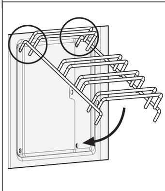
**2.** Die zwei Haken müssen vollständig in den oberen Löchern eingehängt sein. Jetzt das Gestell langsam und vorsichtig nach unten bewegen und in die unteren Löcher eingehängen.
