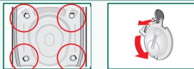
2. Installez les 4 cales de transport et disposez le cordon d'alimentation dans les fixations. Serrez les vis à fond.
