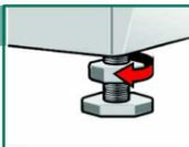
**2.** Pour modifier la hauteur, tournez les pieds de l'appareil. Les quatre pieds de l'appareil doivent fermement reposer sur le sol. L'appareil ne doit pas osciller ! Vérifiez l'horizontalité du lave-linge à l'aide d'un niveau à bulle, rectifiez-la le cas échéant.
