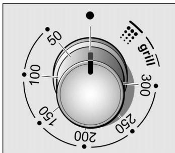
Con el selector de temperaturas se puede ajustar la temperatura, el escalón del grill o el nivel de limpieza.
