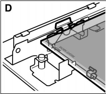
5. Ejercer presión hacia fuera sobre los muelles de sujeción a derecha e izquierda hasta que el vidrio se haya depositado. (figura D)
