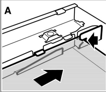
1. Introducir el vidrio inferior de manera inclinada hacia atrás. (figura A)
