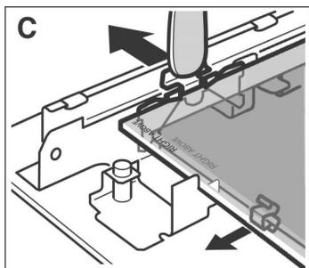
4. Extraer los muelles de sujeción a derecha e izquierda ejerciendo presión hacia fuera. Si hubiera dificultad en extraer las grapas, utilice una cuchara. (figura C)
