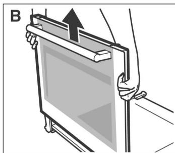
3. Sujetar los vidrios a izquierda y derecha y extraerlos hacia arriba. (figura B)
