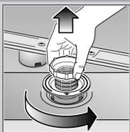
ruotare il cilindro filtri estrarre il sistema filtri ...
