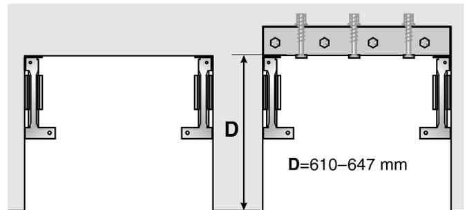
Ist die Einbaunische tiefer als das Gerät, eine starke Holzbohle hinter die Kippsicherungsschienen legen und fest mit dem Untergrund oder der Wand verschrauben.
