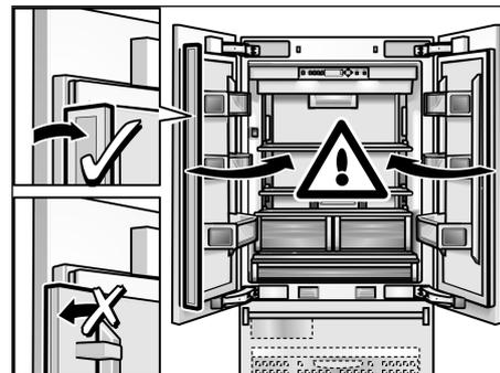
**Vorsicht beim Schließen der Tür! Der an der linken Tür montierte Holm muss beim Schließen der Tür angeklappt sein. Ansonsten sind Beschädigungen am Gerät oder den Möbelfronten möglich.**
