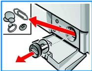
5. Pumpendeckel wieder einsetzen und verschrauben.
