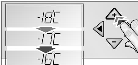
Temperatureinstellung kann mit den Einstell-Tasten + (wärmer) oder - (kühler) verändert werden. Die Temperatur lässt sich in Schritten von 1 °C einstellen.
