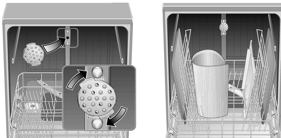
Große Bleche oder Gitter sowie Teller mit einem Durchmesser mehr als 30 cm (Gourmetteller, Pastateller, Platzteller) können Sie mit Hilfe dieses Sprühkopfes reinigen. Entnehmen Sie hierzu den Oberkorb und setzen Sie den Sprühkopf wie in der Zeichnung dargestellt ein.
