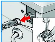
8. Schlauch anschließen und auf Dichtheit prüfen.
