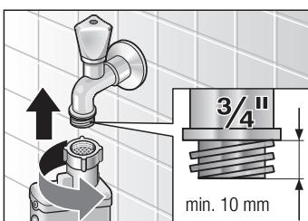
Contrôlez la pression d'eau dans l'installation :
