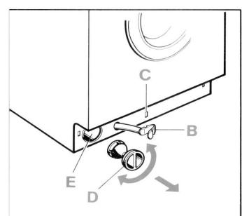
□ Dévissez le couvercle de la pompe **D** en le tournant dans le sens inverse des aiguilles d'une montre. Un peu d'eau résiduelle doit couler.
