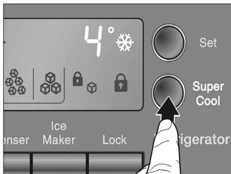
Bei jeder Betätigung der Taste wird die Funktion aktiviert bzw. deaktiviert. Die aktivierte Funktion „Superkühlen“ wird durch das Symbol im Anzeigefeld signalisiert.
