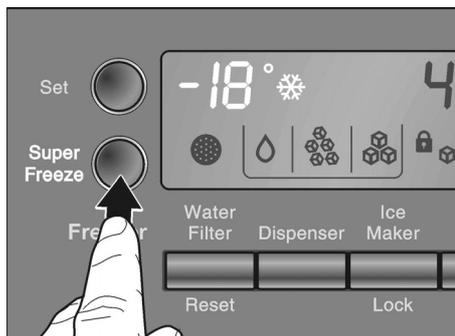
Bei jeder Betätigung der Taste wird die Funktion aktiviert bzw. deaktiviert. Die aktivierte Funktion „Supergefrieren“ wird durch das Symbol im Anzeigefeld signalisiert.
