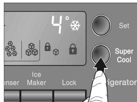
Bij elke aanraking van de toets wordt de functie geactiveerd resp. gedeactiveerd. De geactiveerde functie „Superkoelen” wordt op het display aangegeven door het symbool.
