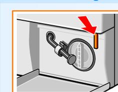
Il programma prosegue quando ritorna l'energia elettrica. Se, tuttavia, occorre prelevare la biancheria, è possibile aprire l'oblò di carico azionando lo sblocco d'emergenza nel modo seguente:
