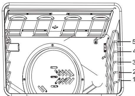
Figure 19 : Position des grilles de four
