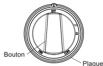
Figure 3 : Bouton de contrôle de brûleur standard
