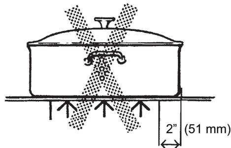
**Figure 10 : Diamètre de la base**
