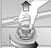
Siebzylinder drehen, Siebssystem entnehmen ...
