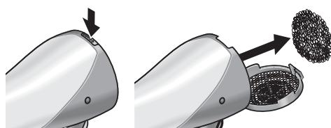
Ouvrez régulièrement la grille d'admission d'air, retirez le filtre qui se trouve derrière puis nettoyez-le avec un pinceau à poils doux. N'essuyez le corps de l'appareil qu'avec un chiffon humide.
