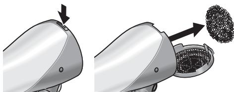
Nosta säädöllisin välein ilmasäleikkö ylös, irrota sen takana oleva suodatin ja puhdista se pehmeällä siveltimellä.
