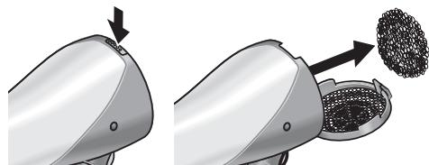
Inntaksgitteret for luft må åpnes opp regelmessig, filteret bak dette må tas ut og rengjøres med en børste.
