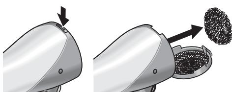
Regelmatig het luchtinlaatrooster openklappen, de achterliggende zeev verwijderen en deze reinigen met een zacht kwastje.
