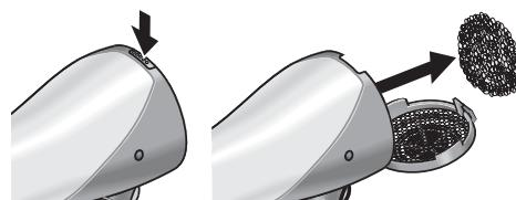
افتح شبكة مدخل الهواء، ثم اخرج المصفاة المتواجدة خلفها ونظفها بفرشاة رسم رخوة وذلك بانتظام دائم. ولتنظيف هيكل الجهاز استخدم فقط قطعة قماش مبللة.
