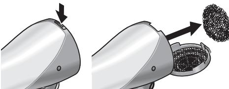
Regelmäßig Luft-Einlassgitter aufklappen, das Sieb dahinter herausnehmen und mit einem weichen Pinsel reinigen.
