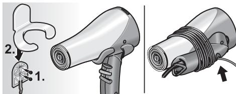
W uchwycie do zawieszenia na ścianie Uchwytu do zawieszenia na ścianie nie mocować w pobliżu wody. Nie przyklejać uchwytu, tylko zamocować przykręcając śrubami.
