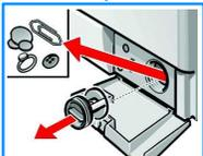
4. Innenraum, Gewinde des Pumpendeckels und Pumpengehäuse reinigen (Flügelrad der Laugenpumpe muss sich drehen lassen).
