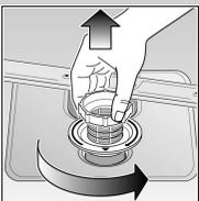
Tournez le cylindre filtrant, retirez le système de filtration...
