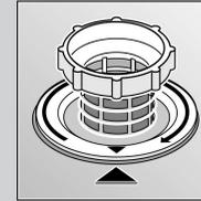
enroscar el filtro cilíndrico
