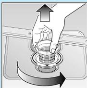
ruotare il cilindro filtri, rimuovere il sistema di filtri ...
