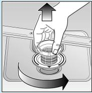
Siebzylinder drehen, Siebssystem entnehmen ...
