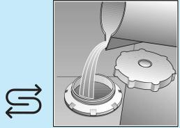
Avant le premier lavage seulement, versez env. un litre d'eau dans l'orifice du réservoir de sel.
