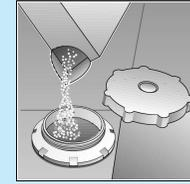
Max. 1,5 kg Spezi­alsalz (nie Reiniger!) einfüllen.
