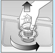
Siebzylinder drehen, Siebssystem entnehmen ...
