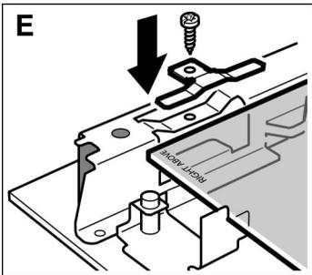
2. Die Klammern aufsetzen und festschrauben. (Bild E)
