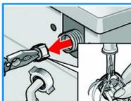
8. Schlauch anschließen und auf Dichtheit prüfen.
