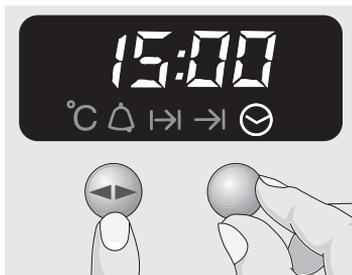
0:00 clignotent à l'afficheur une fois réalisé le branchement électrique de l'appareil ou après une panne de courant.
