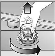
Girar el filtro cilíndrico y extraer el conjunto de filtros ...
