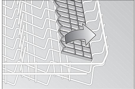
Las piezas largas como cubiertos para ensalada, cucharones (de cocina) o cuchillos se colocan en el soporte adicional para vasos y tazas, de modo que no obstruyan el movimiento del brazo aspersor. El suplemento se puede mover libremente.
