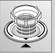
enroscar el filtro cilíndrico ¡PRESTAR ATENCIÓN A LA POSICIÓN DE LA MARCA!
