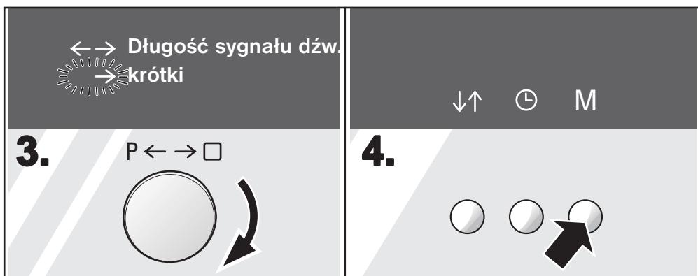
3. Programatorem funkcji zmienić długość sygnału dźwiękowego.
